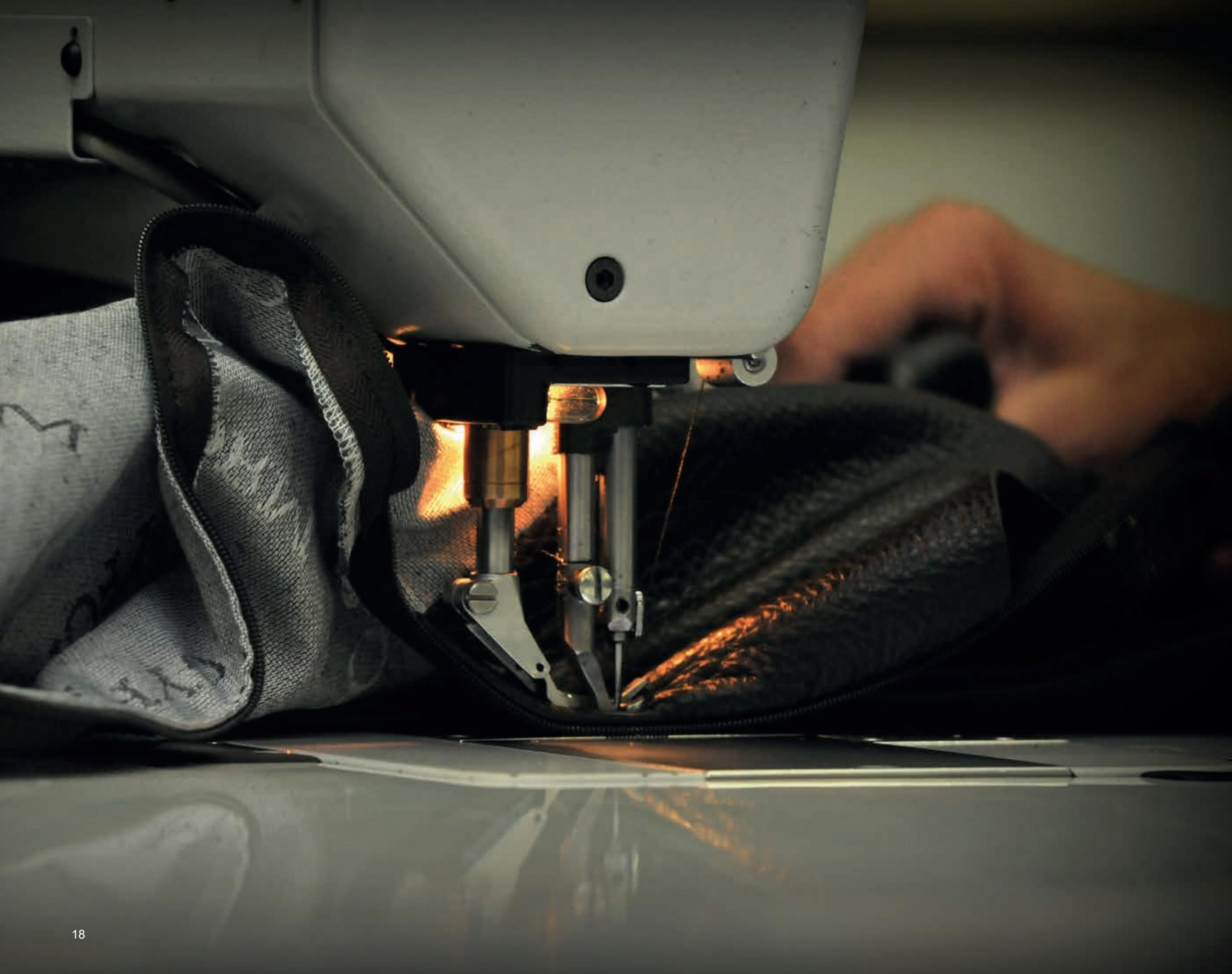
Tessuti e pelli vengono meticolosamente controllati da esperti del settore per eliminare eventuali imperfezioni ed essere avviati alle operazioni di taglio. Una volta tagliate le dime, ogni singolo pezzo viene nuovamente supervisionato. Ordine alla mano, si ricompongono i tagli da inviare al reparto cucitura, dove il personale altamente specializzato si occupa delle finiture.
